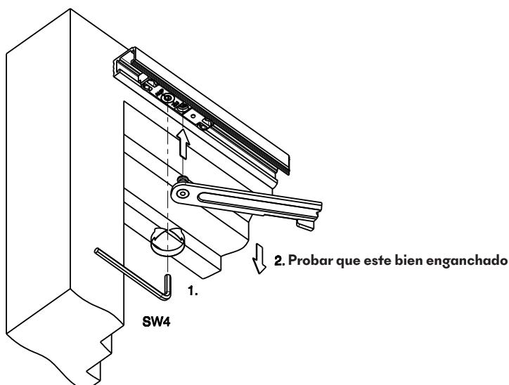
Bloqueo del eje del compás mediante llave Allen 4.
