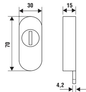
**\*NOTA:** Para colocar la roseta, el bombillo debe sobresalir del perfil mínimo 5 mm y máximo 10 mm.
