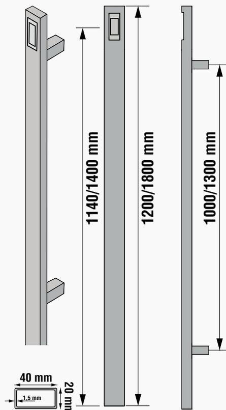
Tirador Rectangular INOX 316 con Lector de Huella dactilar con Bluetooth y Conexión WiFi
