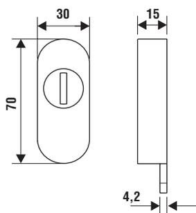
**\*NOTA:** Para colocar la roseta, el bombillo debe sobresalir del perfil mínimo 5 mm y máximo 10 mm.
