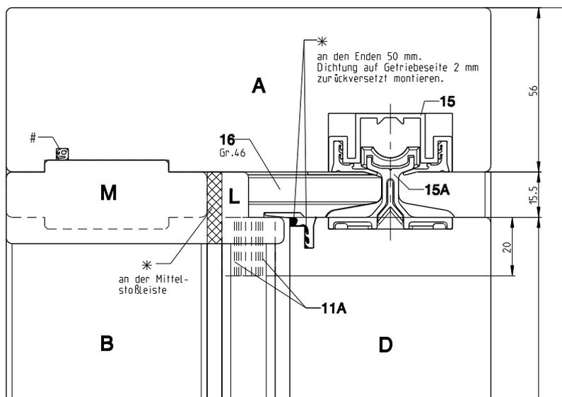
NOTA: La guía P1850 solo es posible usar con guías inferiores de rodadura de altura 5 mm.
