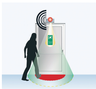
Alarma previa 2: alarma visual/acústica, más foco adicional
