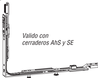
Transmisión de ángulo DK-K basculamiento inferior 6-32292-00-0-1 (Para prolongación)
