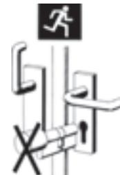
En cerradura anti-pánico nunca se deben de montar cilindros con pomo.
