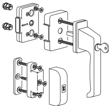
Bolsa de cerrojo superpuesto de seguridad para ventanas y puertas con solapa con manilla DIRIGENT-F/Z para cerrar con llave (Para ventanas o puertas de 1 Hoja)
