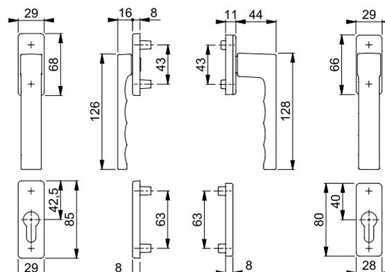
Manilla Hamburgo HOPPE con función SecuForte, de aluminio, para puertas/ventanas correderas-parallelas-abatibles, correderas-parallelas y correderas simples 90°, línea Hamburgo: verificado según RAL-GZ 607/9. Con cuadradillo retráctil de 7x32-42 y tornillos M5x50 y M5x55 incluidos
