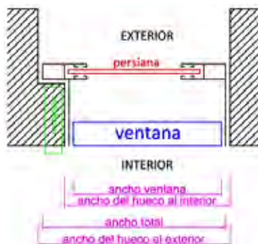
Figura 48. Esquema sección horizontal de ventana con persiana recogedor a la izquierda con solución asimétrica y muro de cerramiento de gran espesor con ancho variable al exterior y al interior
