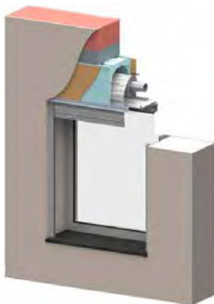
Figura 74. Esquema perspectiva de corte de un cajón túnel en obra
