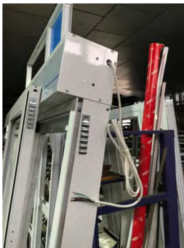
Figura 73. Salida del cableado del motor
