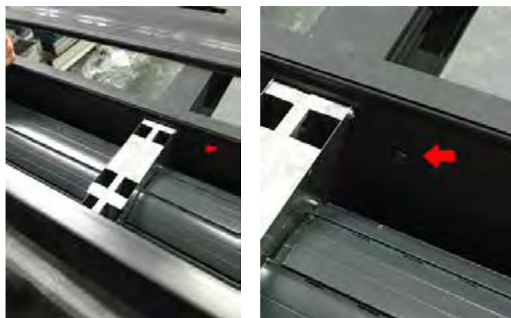
Figura 62. Detalle atornillado visto interiormente. Cuidado que la cabeza del tornillo no perfora el cajón.
