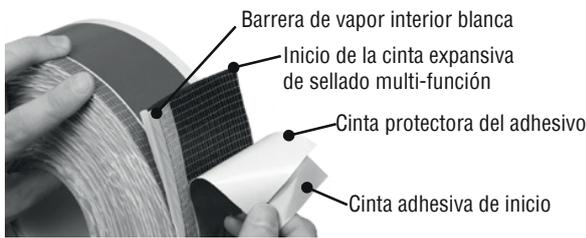
1. Cortar la cinta adhesiva de inicio del rollo usando tijeras o un cuchillo. Despegar la cinta adhesiva de inicio del borde de la barrera de vapor interior blanca y separarlas.
